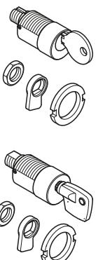
7007114 - Комплект из 5 шт. цилиндров с ключами типа Ronis® для блокировки положения «отключено» встроенным замком
